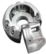
일치용 구멍이 있는 LaserForm Maraging Steel (B) 소재의 블로 성형
