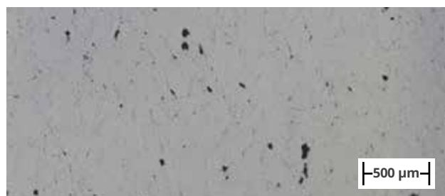
A DMP Flex 350 permite material **de tungstênio totalmente derretido**. O tungstênio puro de fabricação de aditivo contém microfendas e é frágil, limitando seu uso para componentes carregados mecanicamente.
