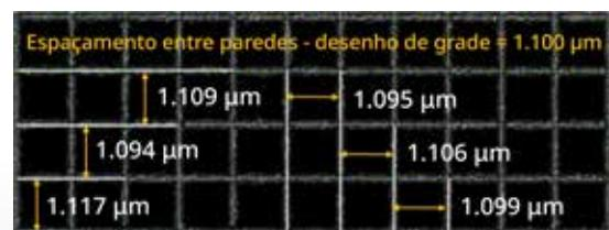
A AM permite um espaçamento entre paredes preciso.
