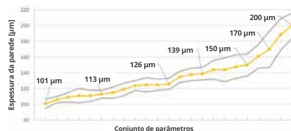
Extenso banco de dados de parâmetros para **espessura de parede personalizável** confiável até 100  $\mu\text{m}$ .<sup>2</sup>
