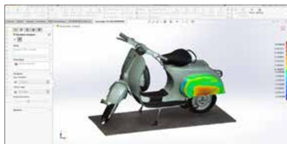
Verifica l'intento e l'accuratezza del progetto. Verifica l'accuratezza del modello rispetto alla nuvola di punti 3D.
